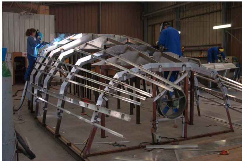
Et lite skip under konstruksjon. Her fra Alubat verftet.
